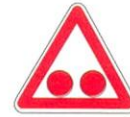
svjetlosni znak za najavljivanje približavanja vlaka, odnosno zatvaranje prijelaza branicima ili polubranicima
